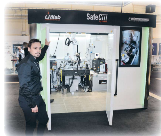
Niklas Larsson visade upp Safe Cell, där LMI AB simulerade automation av handhållen lasersvetsning från IPG Photonics. Lasern klarar rostfritt, aluminium och stål upp till sex millimeter, och är lätt att hantera. Innehåller även program för rengöring som rengör materialet från oxider.
