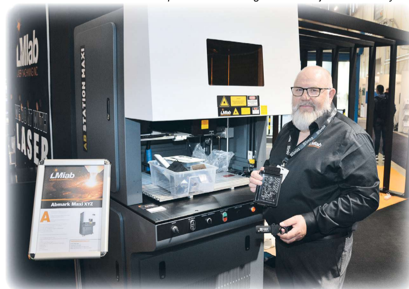
Urban Gärd, produktansvarig lasermärkning, demonstrerade lasermärkmaskinen Abmark Maxi XYZ som används för att märka eller gravera i metall i alla möjliga branscher. Maskinen anses vara optimal för märkning av större objekt i större volymer.
