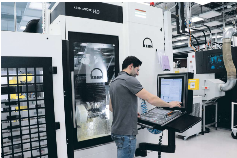
Innan skiftet är slut installerar IWC-specialisten Fabian Vogt sin Kern Micro HD och utrustar den med tillräckligt många arbetsämnen. Då producerar precisionsmaskinen tillförlitligt och automatiskt bottenplattor till verken – även under hela helgen.
