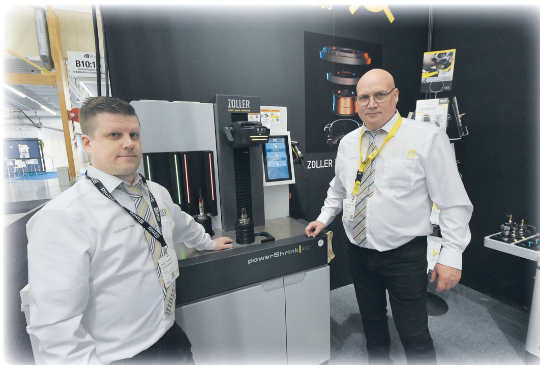
Från vänster: Pauli Keski-Saari, Ulf Närvall, visar ZOLLER PowerShrink400 med scanner för att scanna QR koderna på hållarna varpå induktinsspolen automatiskt ställer in rätt diameter och värme-krympningen kan börja.
