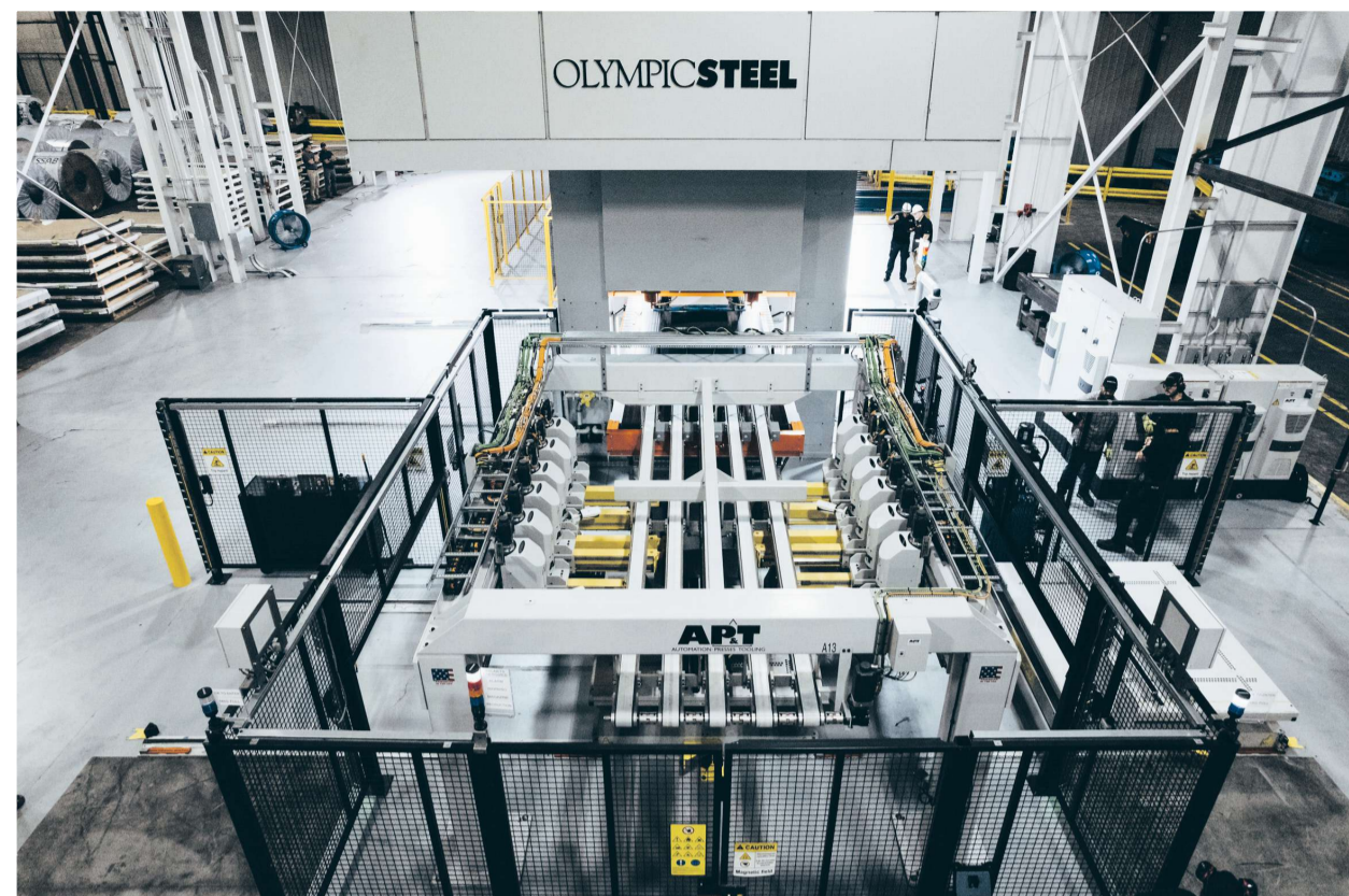
Tolv ställarmar ser till att varje ämne hamnar i exakt rätt position
