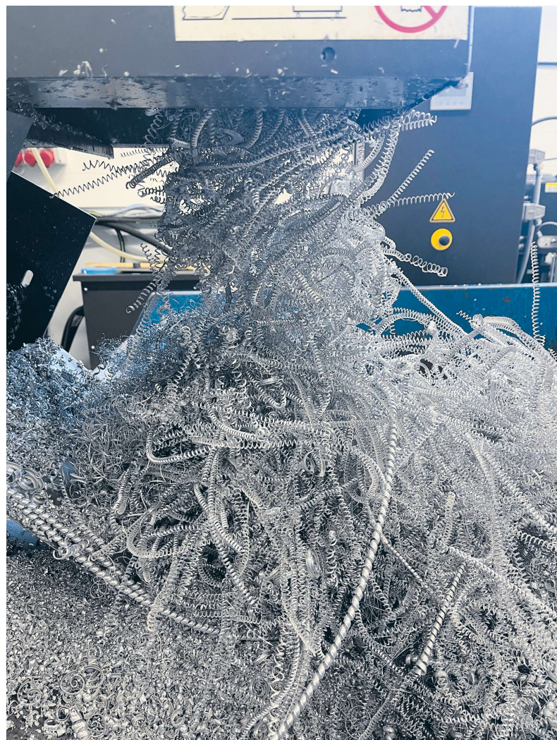
Trassligt (lång)spån kräver ständig tillsyn av maskinen och risk för haveri av spåntransportör. Hanteringen av spånet blir komplicerat, dyrt och inte miljösmart! RAPTOR är lösningen!
