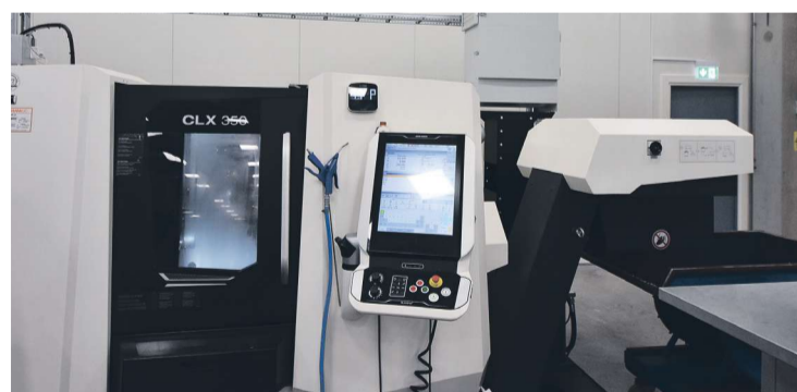
A.mist6C är Absolents mest kompakta filterenhet för smidiga och kreativa installationsmöjligheter. Till denna maskin har man placerat filterenheten på ett golvstativ för att inte störa driften av maskinen men samtidigt komma nära källan och kunna säkerställa ren luft för operatören.
