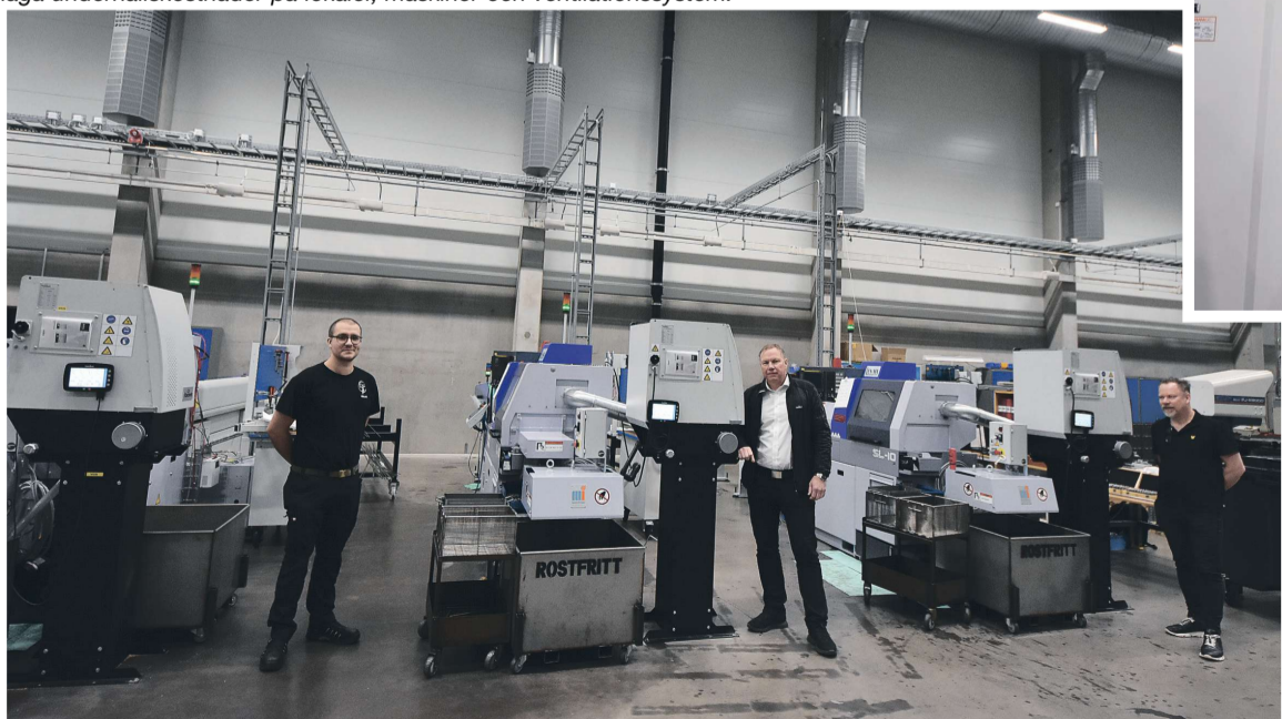
A.mist6C är Absolents mest kompakta filterenhet för smidiga och kreativa installationsmöjligheter. Till denna maskin har man placerat filterenheten på ett golvstativ för att inte störa driften av maskinen men samtidigt komma nära källan och kunna säkerställa ren luft för operatören.
