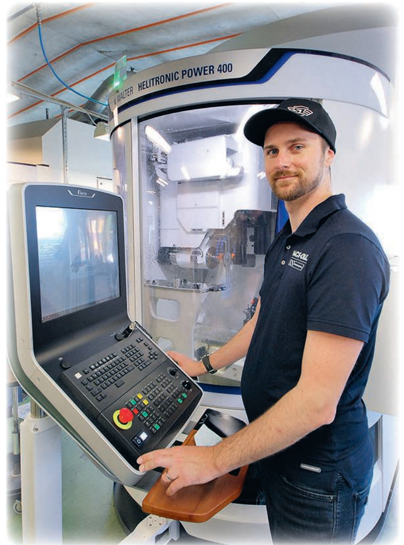
I maskinparken finns det senaste tillskottet -Helitronic Power från tyska Walter. En CNC-maskin med den senaste teknologin som slipar såväl större serier som enstaka verktyg.
