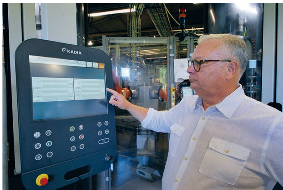
”Automatisk mätning i maskinerna visas på bildskärmen och maskinerna korrigerar automatiskt in till rätt tolerans”
