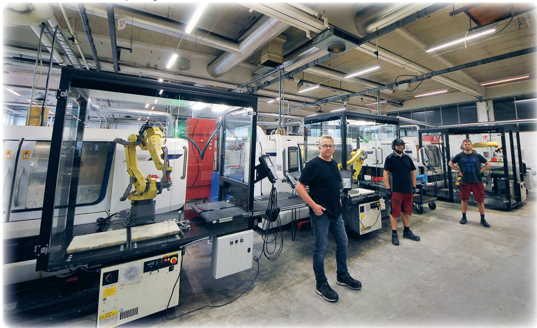
Robotceller i 2-skift i den automatiserade slipavdelningen.
