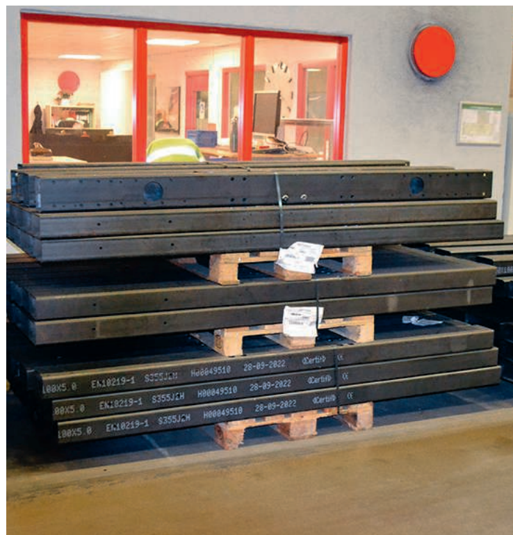
Balkar skurna i rörlasermaskinen
