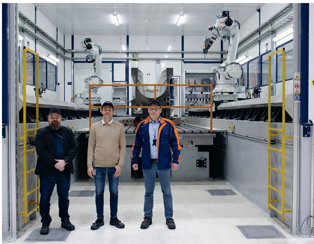
Från vänster Rami Hakala Wärtsilä, Henrik Brodén Fastems och Tero Kujamäki Wärtsilä – framför en robotautomatiserad avgradningscell.
