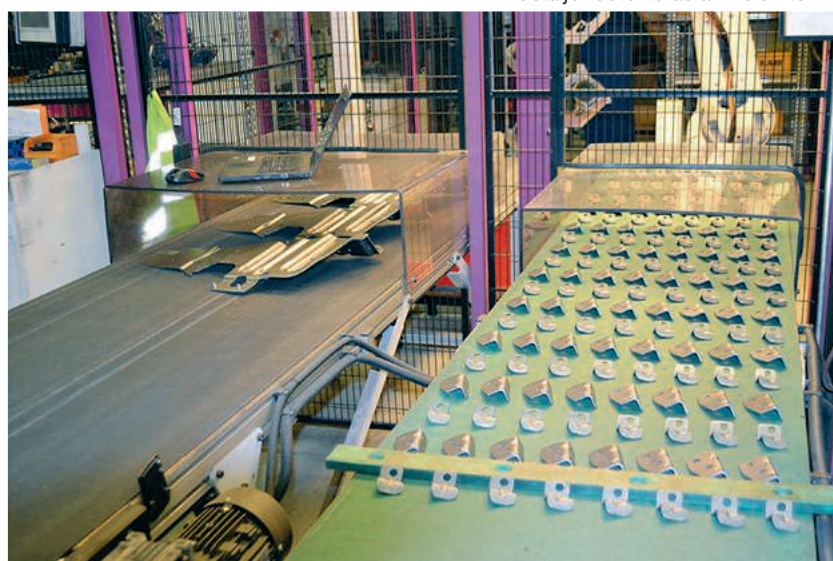
Cellerna riggas manuellt och detaljer detekteras av vision teknik
