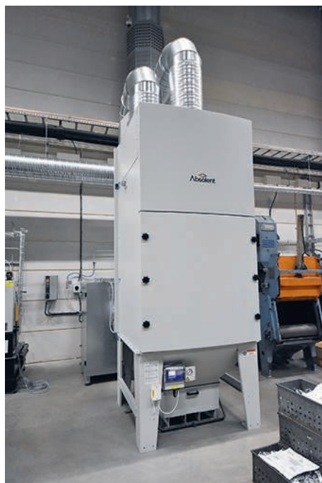
Absolents torrstofffilter A.dust15 med down flow teknik för lång och underhållsfri drift. Detta filtersystem tar hand om torra partiklar som i det här fallet uppkommer vid slipning, blästring och trumling.
