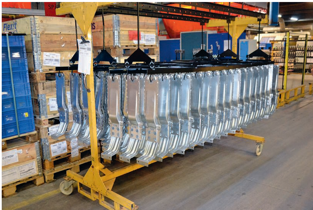
Automatsvetsade detaljer före ytbehandling
