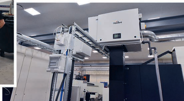
Ett väl fungerande filtersystem ska utföra två saker, skapa ett bra undertryck i maskinutrymmet och rena luften det suger från skadliga partiklar. A.mist10C från Absolent gör precis det. I ett kompakt format för att passa alla tänkbara förutsättningar är det ett litet filter med stor kapacitet.
