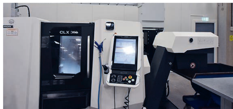
A.mist6C är Absolents mest kompakta filterenhet för smidiga och kreativa installationsmöjligheter. Till denna maskin har man placerat filterenheten på ett golvstativ för att inte störa driften av maskinen men samtidigt komma nära källan och kunna säkerställa ren luft för operatören.
