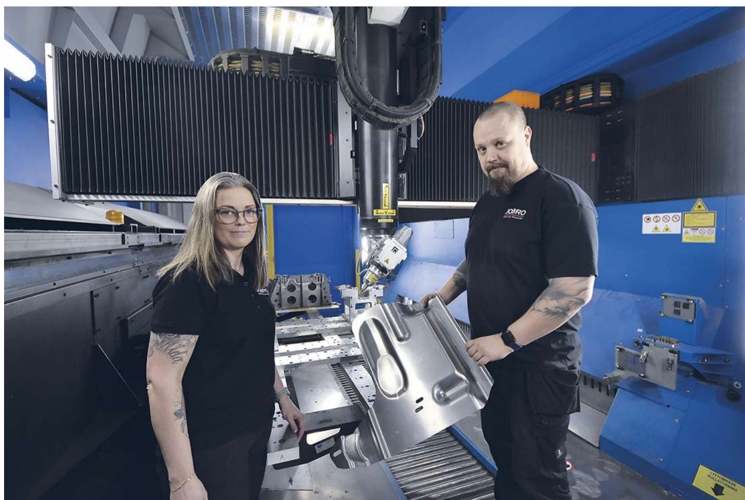
Skuren plåt detalj som i många fall med sin komplexitet först laserskurits i en 2D laser, sedan vidare till pressning och slutligen hamnar i 3D lasern för slutformning. På fotot ser vi Erika Algotsson och Jouni Takkinen.
