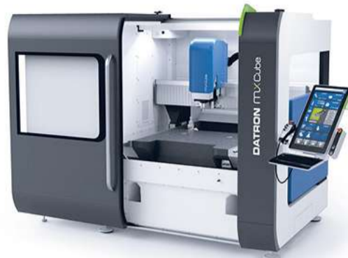
DATRON MXCube särskilt utvecklad för mycket krävande HSC-strategier.
