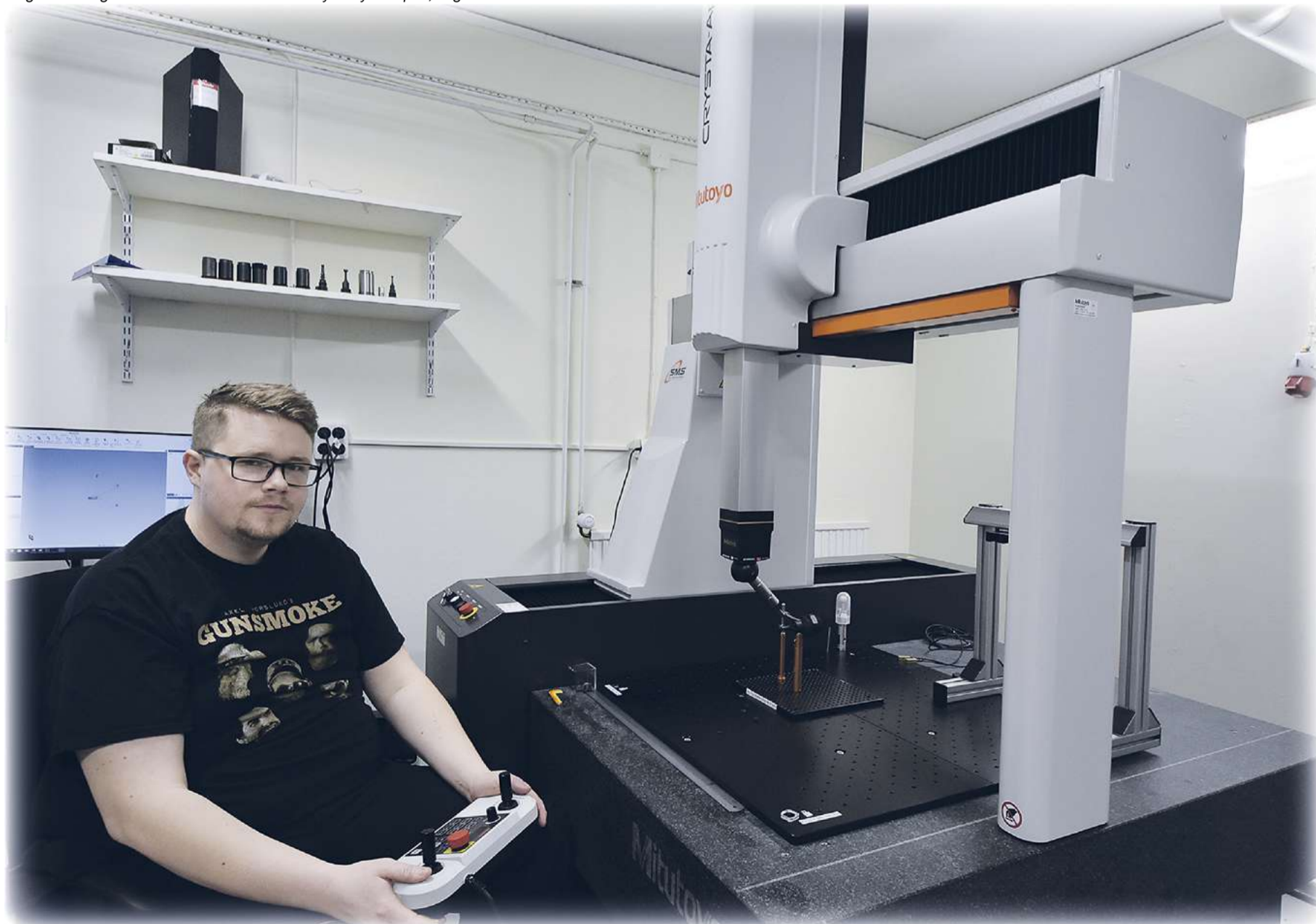
Vi gör mätningar i koordinatmätmaskin Mitutoyo Crysta Apex, säger mättekniker Dennis Eriksson.
