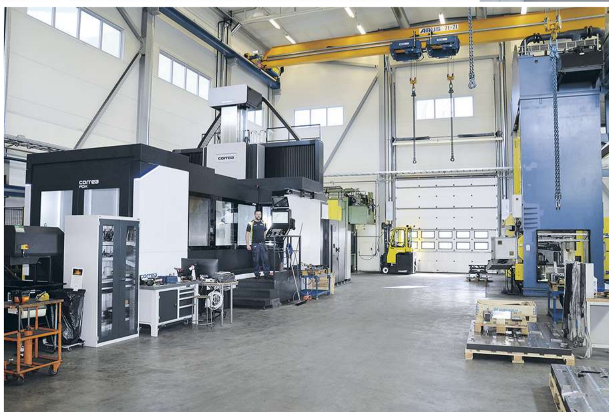
Välplanerad verkstad med kort avstånd mellan portalfräsmaskinen och pressen. Med två decimeter på varje sida till godo står den nya maskinen på samma fundament som förra portalfräsen.
