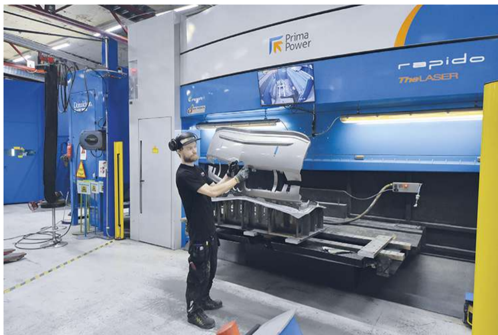
Färdigformad plåt detalj efter 3D fiberlaserskäring.
