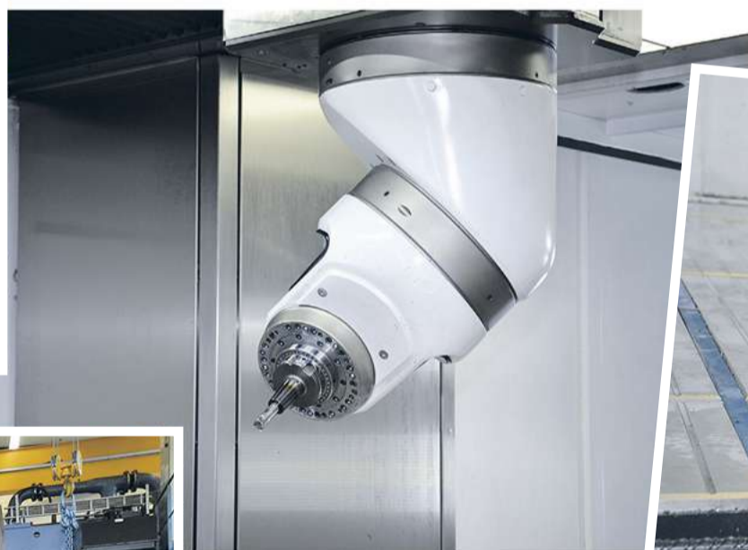
Correa FOX40 är utrustad med ett automatiskt UDX-fråshuvud med 10 000 rpm och 640 Nm. Produktionstiden på verktygen är mellan 15 och 45 veckor beroende på storlek och hur avancerad bearbetningen är.
