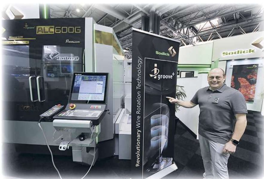
Trådgnist SODICK ALC 600G med integrerad teknik – iGroove = roterar tråden under andra skäret och följande skär. På så sätt utnyttjar man tråden runt om i stället för endast på en sida som vid konventionell trådgnistning. Detta ger bättre ytfinitet, högre noggrannhet samt mindre trådkonsumtion, sa Roger Jansson.
