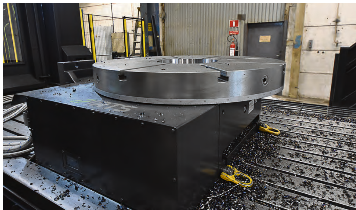
V/H Rundbord på 1000 mm i diam. Maxvikt 4 ton. V/H betyder att bordet kan ställas både vertikalt och horisontellt, i horisontellt läge behövs därav en dubbdocka för att rotera bitar i luften. Indexering 0,001 grader samt fullt simultan CNC bearbetning.
