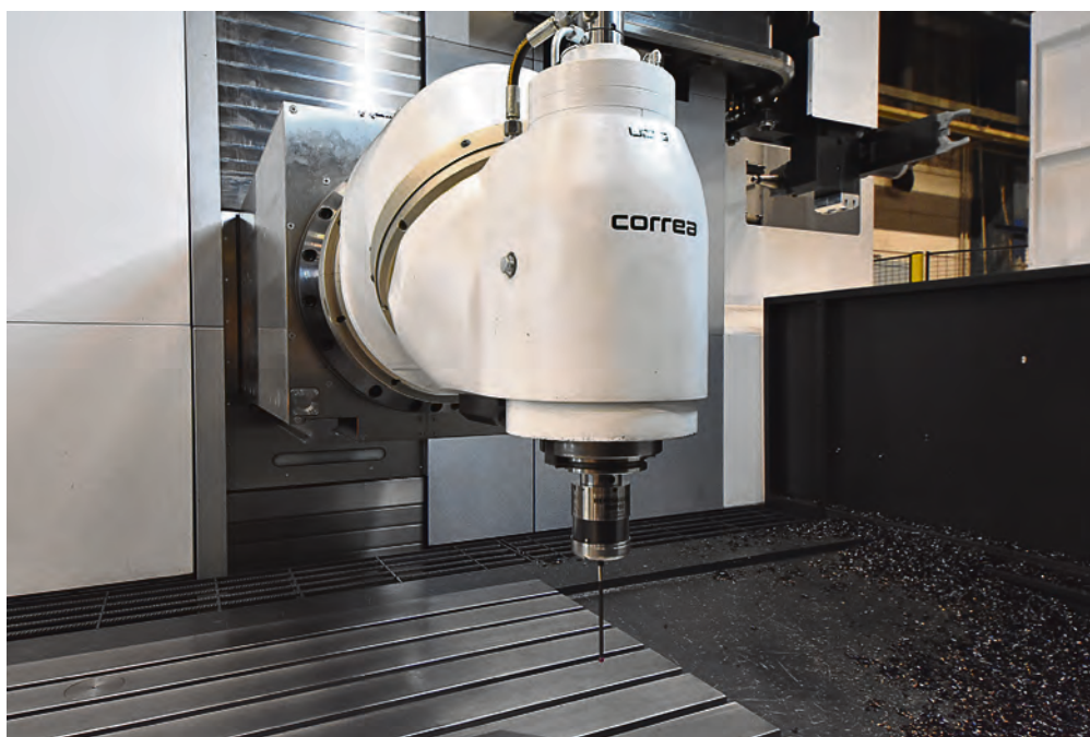
Nicolás Correa söker ständigt efter mekaniska system som minimerar elektroniska kompensationer så mycket som möjligt. Detta hjälper maskinerna att behålla sin geometri längre. Indexerande Correa-fråshuvuden behåller sin geometri tack vare hirth-kopplingar. Detta innebär att självkalibreringscykler inte är nödvändiga när man arbetar med Correa's indexerande fråshuvuden.
