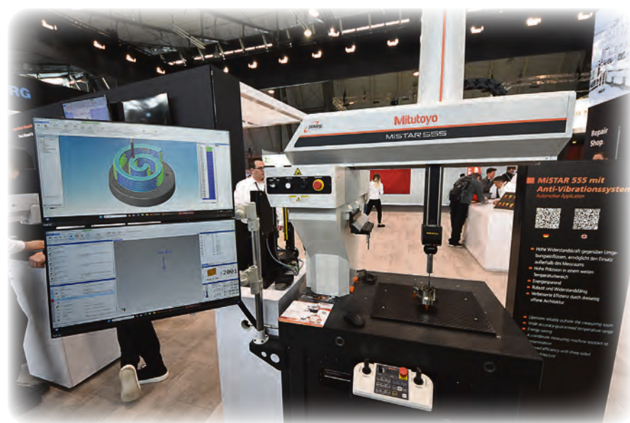
MISTAR 555 med vibrationsdämpande system. Mycket miljötålig koordinatmätmaskin för inspektion direkt i produktionen, utanför mät-rummet.
