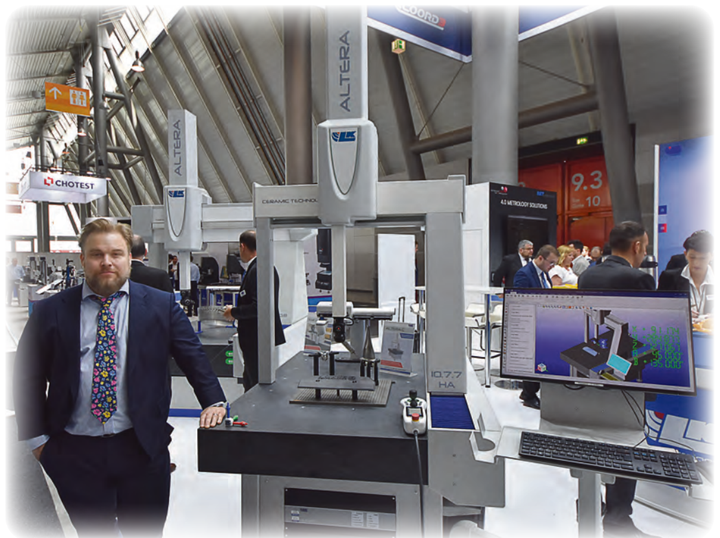
Markus Framför en Keramisk LK Altera C. En liten kompakt CMM för fabriksgolvet eller mättrummet.
