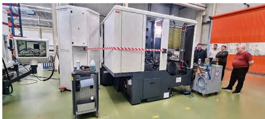
En ACURA 65EL med standbymagasin och totalt 245 verktygsplatser som inom kort levereras till Mora CNC, företagets fjärde ACURA 65.
