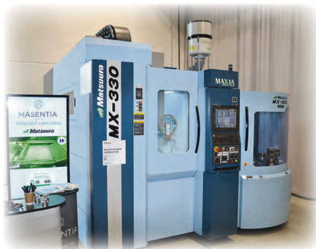
Under Värnamo Industriexpo lyfte MASENTIA fram den femaxliga fleroptionsmaskinen Matsuura MX-330 PC10 med automation lite extra.
