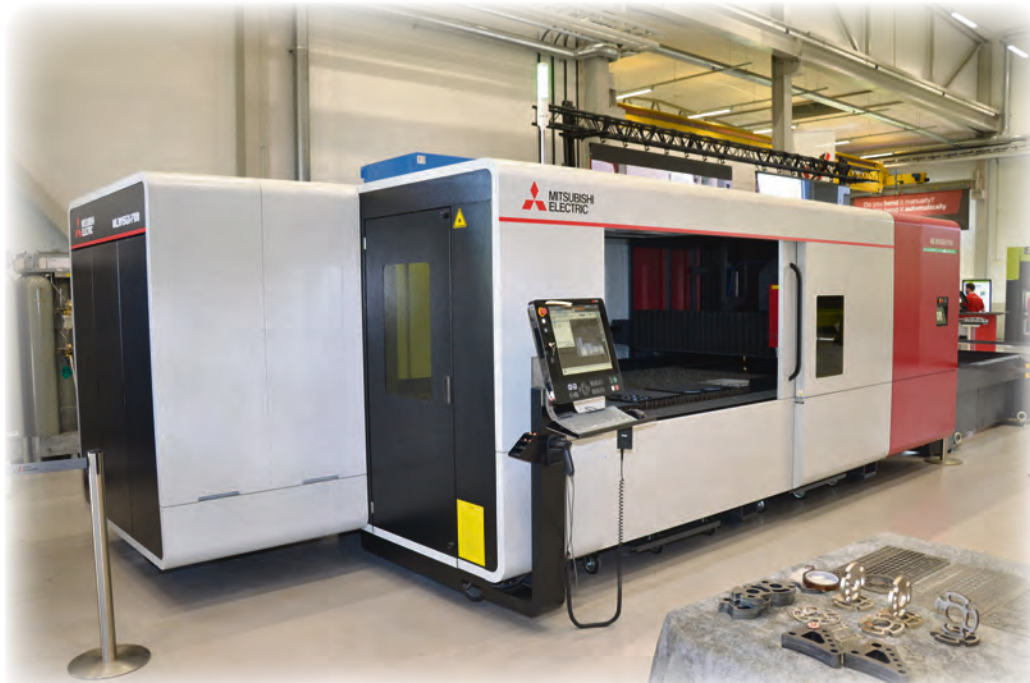
Lasermaskinen Mitsubishi ML3015GX-F100, som har inbyggd AI och optimerad skärprocess, kan användas till både fler- och enstycksproduktion.
