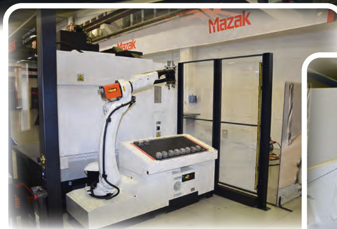
Mazak CV5-500 - en flerooperationsmaskin med hög tolerans och stabilitet, kan med enkelhet integreras med olika automationslösningar. Med robot vid sidan av maskinen kan operatören arbeta vid maskinens front/framsida.
