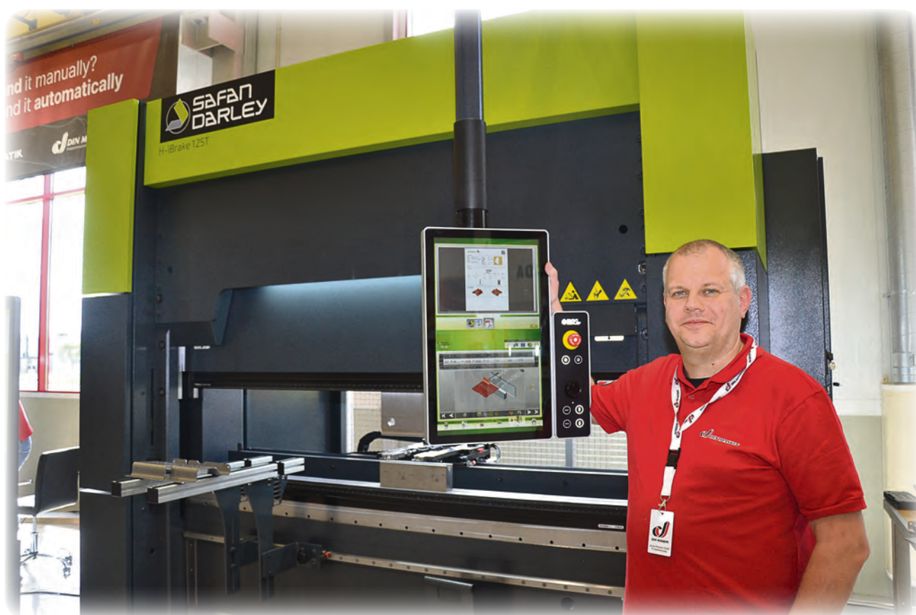
Jonas Persson Svärd, ny produktansvarig för kantpress vid Din Maskin, visade upp den nya kantpressen H-iBrake 125T från SafanDarley, och möjligheten till offline-programmering via AutoPol.
