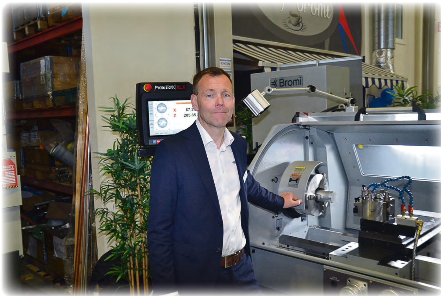
Bromi Gruppen har ett stort utbud av maskinlösningar och under Värnamo Industriexpo visade Martin Paland, vd för Bromi Gruppen, bland annat upp lättprogrammerade fåstycks-maskiner som RLX 355 med ProtoTRAK. Den stabila svarven är specialutvecklad för enstycks- och småserietillverkning, och har ett lättillgängligt arbetsutrymme med en sving över bädd på 360 millimeter.
