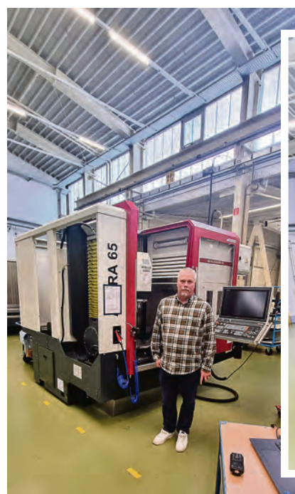
En ACURA 65EL med standbymagasin och totalt 245 verktygsplatser som inom kort levereras till Mora CNC, företagets fjärde ACURA 65.
