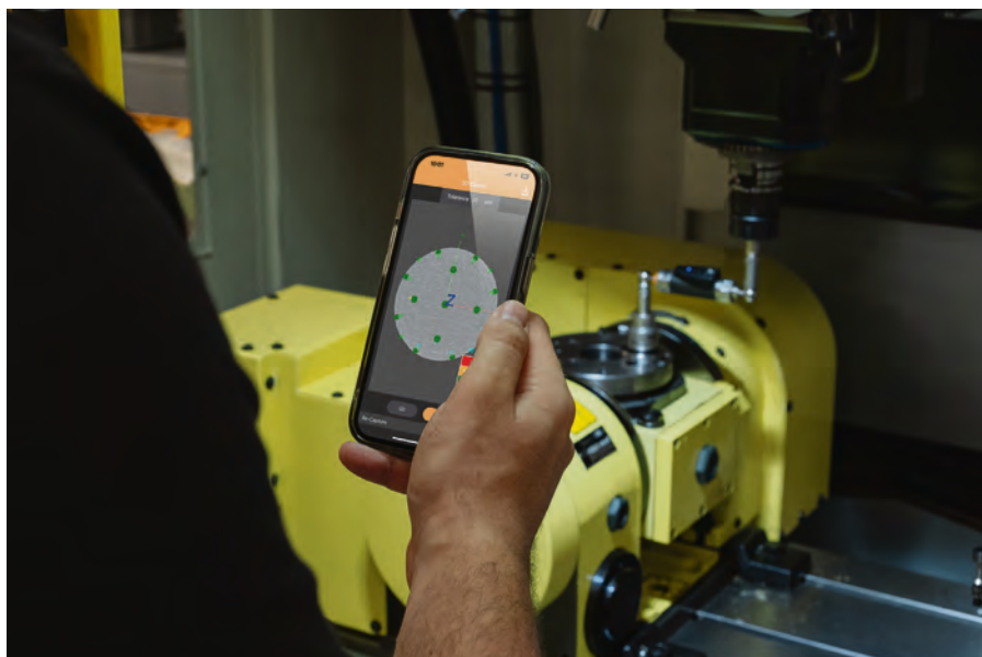
Handhållen mobilenhet som visar sfärisk avvikelse i CARTO Ballbar appen med QC20 ballbar i bakgrunden.
