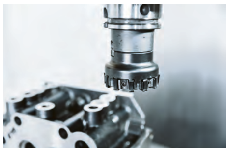
Som standard finns MaxiMill – S-Power-fråsarna i diametrarna från Ø 56 till Ø 125. Ställvinkeln på 88° möjliggör ett maximalt antal skäreppor, och de omkretsslipade vändskären sörjer för snäva toleranser och hög ytkvalitet.
