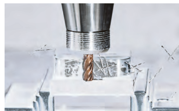
För att leda bort maximalt med värme har MonsterMill – ISO-S justerats geometriskt så att det redan under bearbetningsprocessen alstras minsta möjliga värme. Tack vare polerade spånsår och en perfekt anpassad beläggning minimeras friktionen och ett effektivare spånflöde säkerställs.
