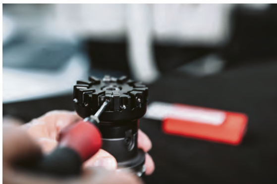
Med maximalt antal dubbelsidiga vändskär levererar MaxiMill – S-Power högsta prestanda och en extremt stabil och vibrationsdämpande konstruktion.
