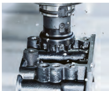
Som standard finns MaxiMill – S-Power-fråsarna i diametrarna från Ø 56 till Ø 125. Ställvinkeln på 88° möjliggör ett maximalt antal skäreppor, och de omkretsslipade vändskären sörjer för snäva toleranser och hög ytkvalitet.
