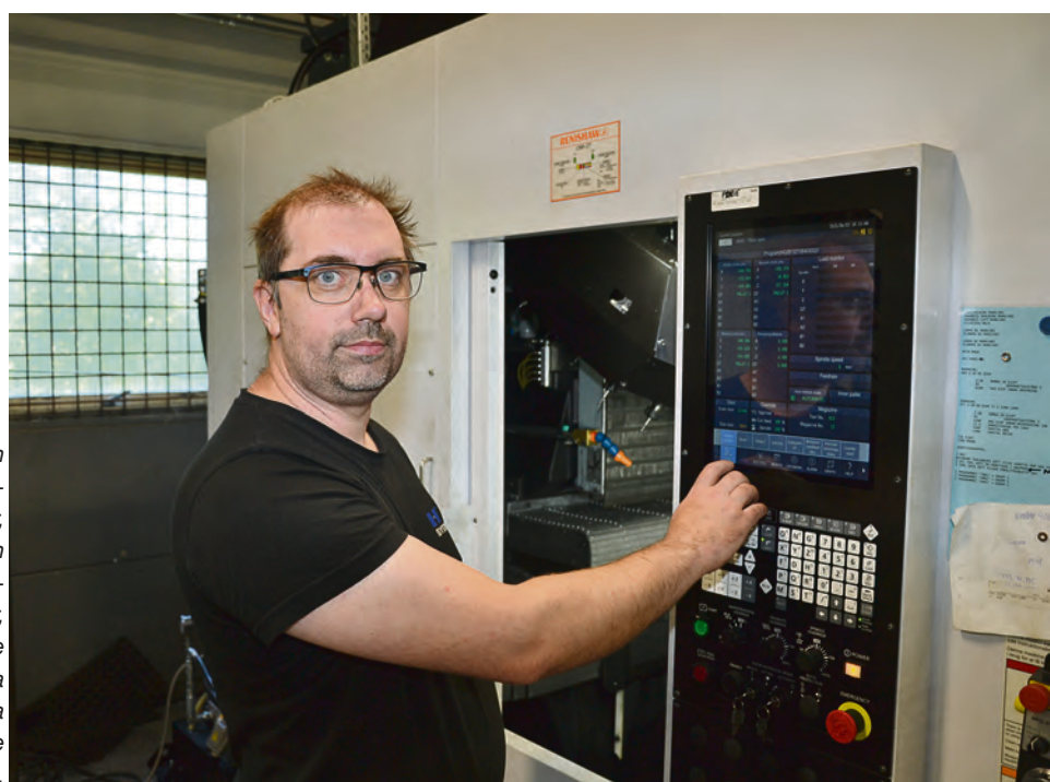
I produktionslokalen finns sex fleroperationsmaskiner, en lasermaskin, en långsvarv, en CNC-svarv, två blocksågar, två tvärsågar och tre robotar i drift. Flera av investeringarna har skett under de senaste två åren.
