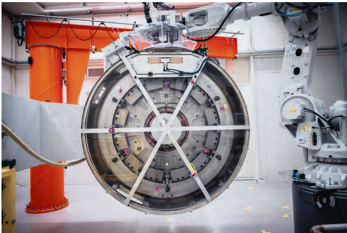
En produktionscell för DED (Directed Energy Deposition) och lasersvetsning på GKN Aerospace i Trollhättan.
