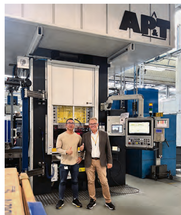
Peter Lund Pedersen från Grundfos och Peter Karlsson från AP&T firar installationen av ett världsunikt servohydrauliskt press-system med fritt programmerbart styrsystem, realtidsövervakad energiförbrukning och upp till 85 % lägre energianvändning per slag som de har utvecklat tillsammans.
