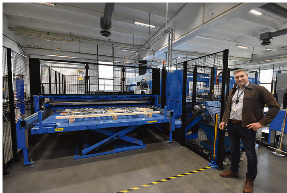
som är en automatisk inmatnings- och staplingsrobot med hög prestanda. LST-roboten matar in plåtarna i maskinen, plockar upp detaljerna och sorterar dem i staplar som ska användas i följande processteg. Roboten kan utrustas med flera ytterligare bord och vagnar, och kan även integreras med automatiserade lagringslösningar.
