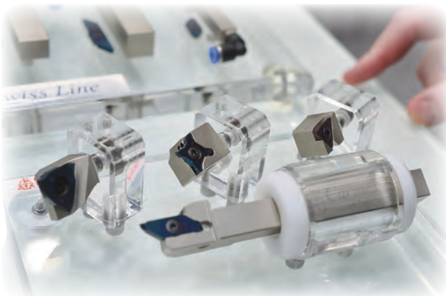
Quick change, utbytbar modulhuvud från CPT.
