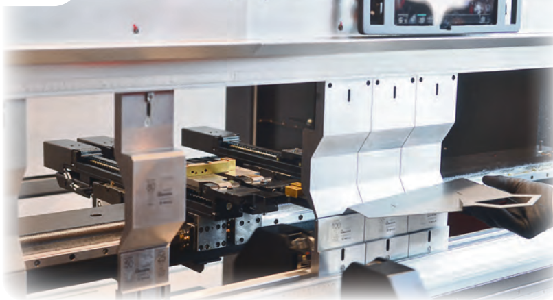
Nya innovationer, till exempel det unika trefinger bakre anslag för stabil mätning av komplexa detaljer.
