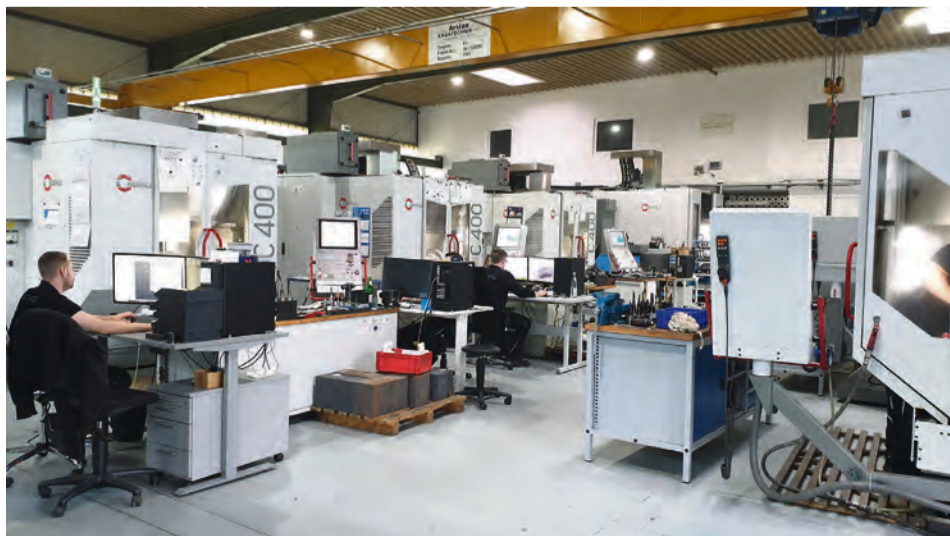
Fleroperationsmaskiner från Hermle används för tillverkning, med programmering direkt vid maskinen. ©MAPAL
