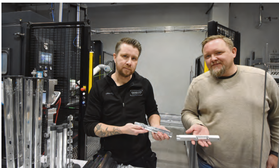
Här visar Emil och Andreas en komponent före och efter blästring. Blästring som metod används för att ge detaljerna en matt yta före anodiseringen. Här används keramiskt blästermedia som säkerställer resultatet varje gång.
