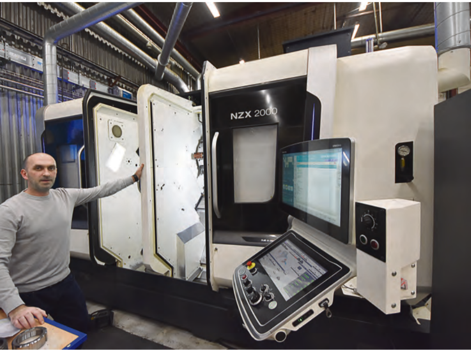
Avancerad och intressant maskinteknik - DMG Mori NZX 2000 med mellanvägg. - VK Mekaniska började med att investera i en NZX 2000/8 med mellan vägg. Detta innebär att det blir som en "pendel" maskin, dvs att de öppnas en lucka i mellanväggen så att man kan docka tempo 1 till mot spindeln för att köra tempo 2. Därefter går det att ladda in nytt råämne i spindel 1 medan man kör tempo 2 färdigt. Detta var första maskinen med mellanvägg i Norden som DMG MORI sålt, berättar maskinsäljare Anders Wikström.
