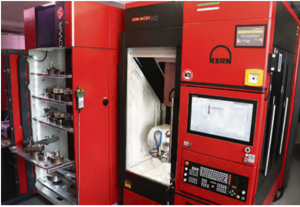
I drift hos toolcraft sedan 2024: Kern Micro HD femaxligt precisionsbearbetningsmaskin utrustat med ett slipfunktion.
