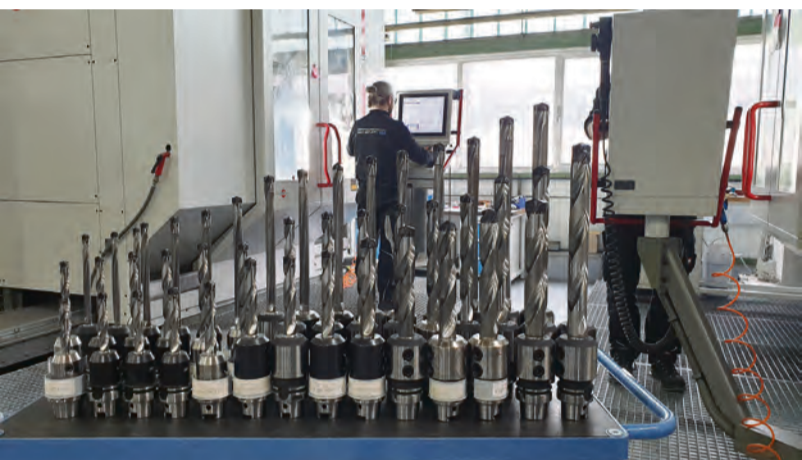
Det omfattande verktygspaketet från MAPAL innehåller 110 TTD-borrar med utbytbara huvuden i diametrar från 12 till 45 mm och längder upp till 12xD. ©MAPAL
