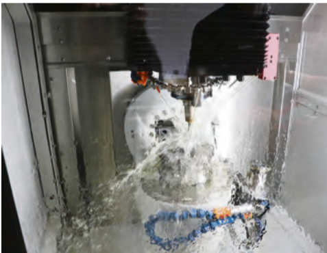
Högprecisionsfräsning och slipning med olja på Kern Micro HD ger de högsta noggrannheterna inom toleransområdet upp till 1,5 µm för arbetsstyckena.
