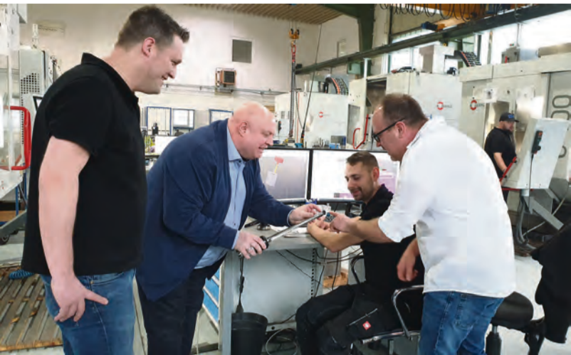
Kontroll av borrhuvudet på ett TTD-verktyg – en del av optimeringsprocessen med MAPALs system. ©MAPAL
