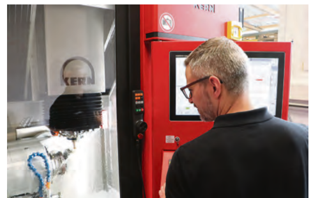
Efter att programmet har startat tar maskinoperatören Matthias Grän en snabb titt på bearbetningen av detaljen. Efter det kan den fullt automatiserade Kern Micro HD med slippaket även arbeta utan operatörer i mer än 150 timmar om det behövs.
