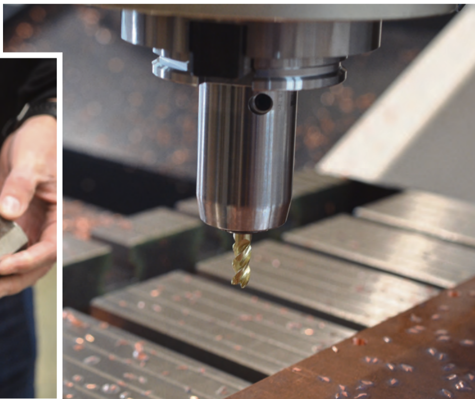
Pinnfräs från Inova med 3 invändiga kylkanaler. På bilden bearbetas kopparmaterial.
