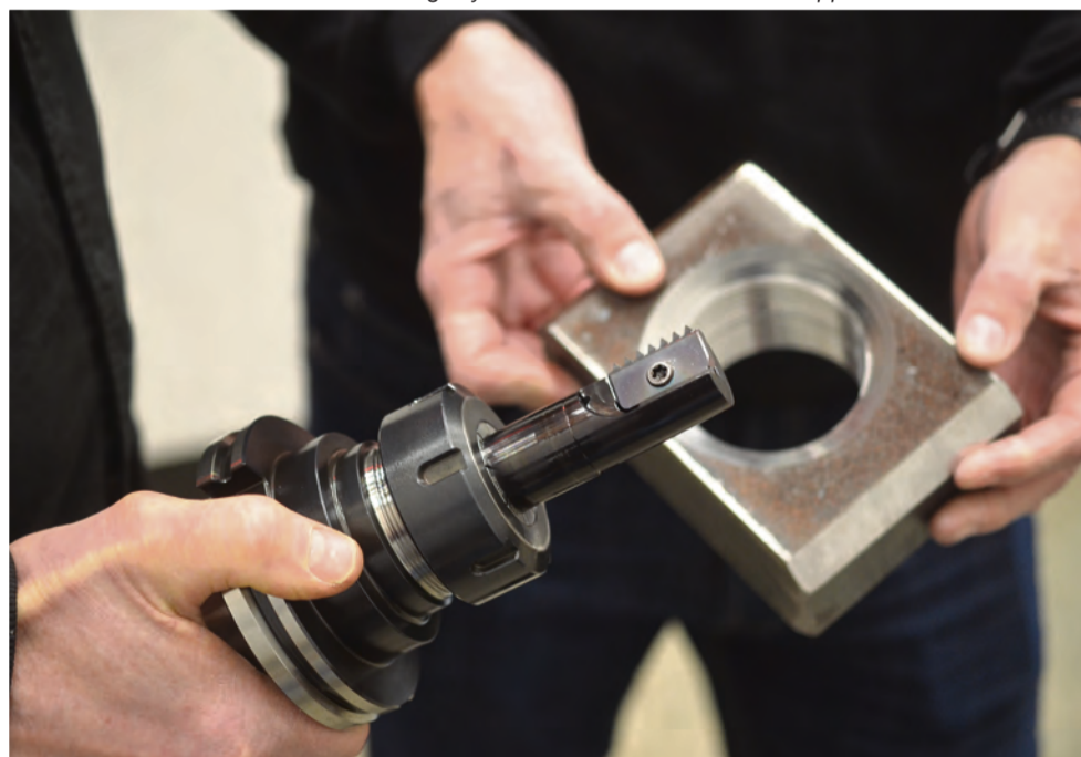
Pinnfräs från Inova med 3 invändiga kylkanaler. På bilden bearbetas kopparmaterial.
