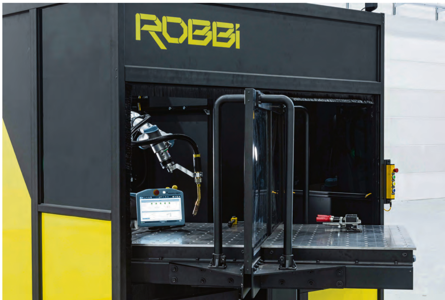
ESAB:s nya ROBBI 360 inneslutna cobot-svetscell och Tracfinder-serien av batteridrivna svetsstraktorer ökar produktiviteten jämfört med manuell svetsning.
