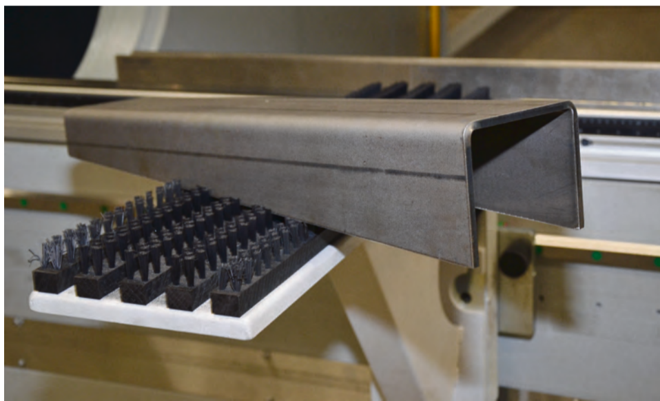
En av flera detaljer till sågverksindustrin som Bengtsson Steelworks har tillverkat i sin nya specialanpassade kantpress Adira PH50040.
