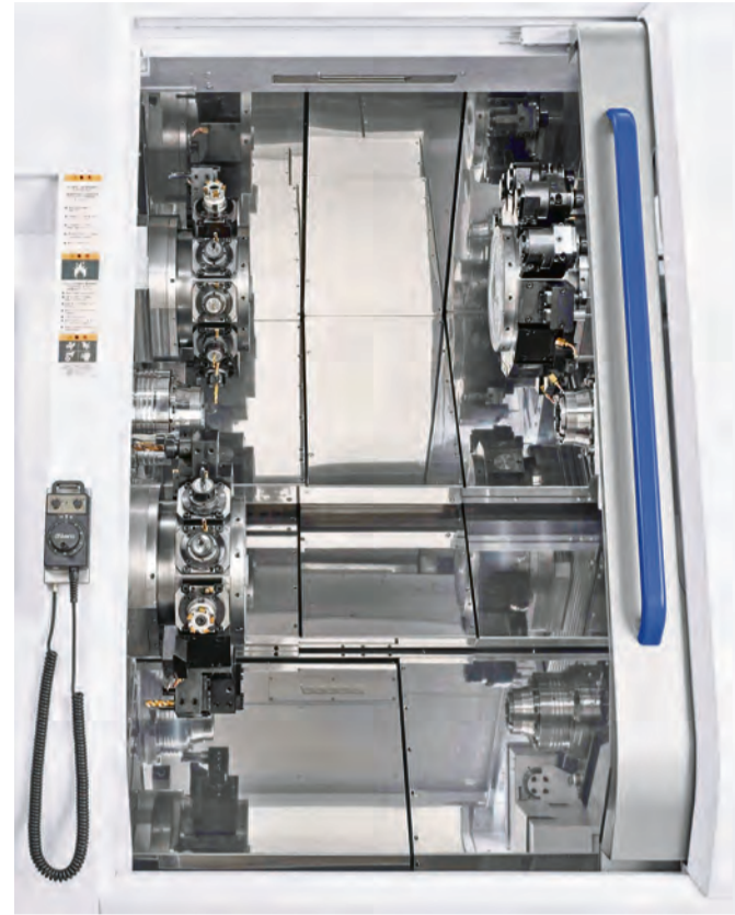
Tredje generationens Citizen Miyano ABX-80THY svarv med fast spindeldocka och stångmatning är utrustad med tre revolverhuvuden, som var och en har \pm 40 mm Y-axelrörelse
