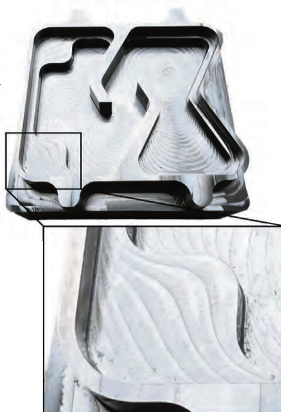
Bild 2: Jämförelse mellan en simulerad bearbetning och verklig yttopografien. Redan efter den första bearbetningscykeln blir det tydligt hur den verkliga komponenten kommer att se ut. Varje matningsavtryck för samtliga skär syns tydligt i simuleringen
