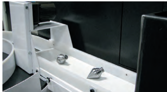
De färdiga detaljerna ramlar ned på bandet och transporteras till det roterande bordet.
