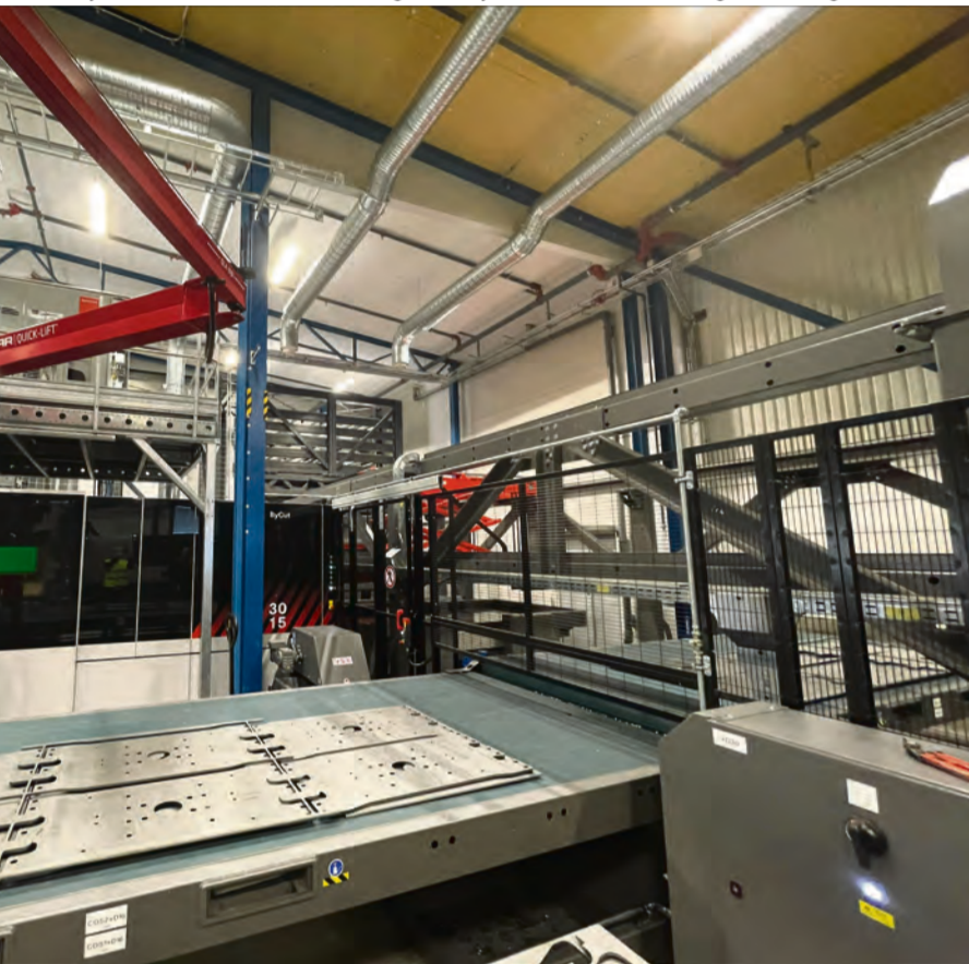
ByCut Fiber 3015 10 kW - Integrerad ByTrans Modular lastnings-/lossningsautomation
