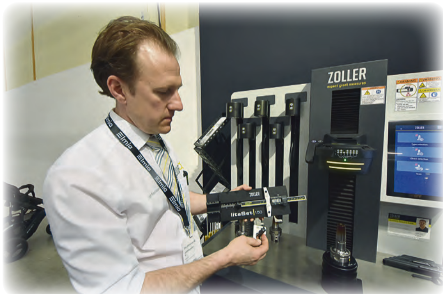
Josef visar ZOLLER liteSet som är ett uppskattat tillbehör till ZOLLER PoweShrink för att enkelt krympa i verktygen till ett specifikt utstick från hållaren.
