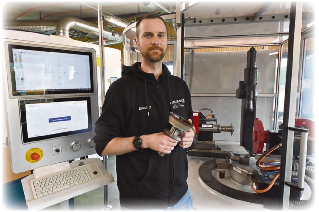
Automatiska laddare och mätprob gör att slipningen kan ske obemannat under längre perioder. Detta minskar kostnader och ökar kapaciteten. Allt övervakas av mjukvara och kameror i verkstaden.
