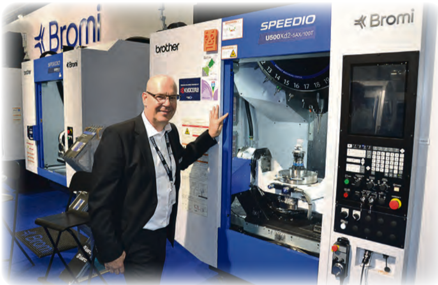
Johan Martinez, försäljningschef för Bromi Gruppen, visar upp Brother U500Xd2-5AX/100T som fick mycket uppmärksamhet under mässan. U500Xd2-5AX/100T är en flexibel 5-axlig bearbetningsmaskin med stort arbetsområde.
