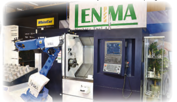
Den horisontella svarven - Hi-TECH 230BL YSMC - utrustad med automationscell. LENIMA Machine Tool tror att HWACHEON kan tilltala både mindre och större verkstäder som vill ha mycket maskin för pengarna.
