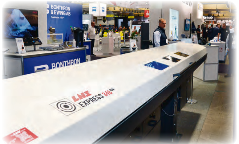
Med LNS Express 346, som hanterar stänger med en diameter på 3 till 46 millimeter, får kunden snabba omställningar, minskade vibrationer, automatisk reststängshantering, och automatiskt kanalbyte.
