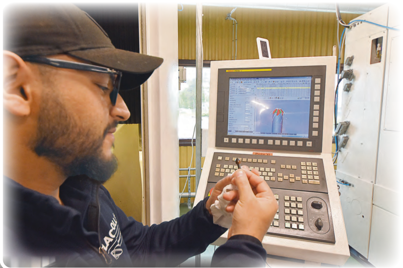
Processen från design till färdigt verktyg där verktygets geometri modelleras i specialiserade program som Walter Helitronic Tool Studio. Här definieras parametrar som spiralvinkel, spånvinkel, radier och skärkanter.
