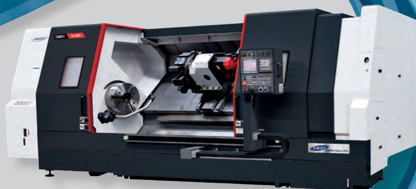
SMEC SL8500 Kraftfull storsvarv med 32" chuck och 5 050 mm svarvlängd
