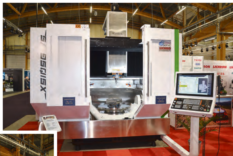
5-axliga flerooperationsmaskinen Hartford 5A-95Q har ett rundbord på 800 millimeter, ett rörelseområde på 950 x 850 x 650 millimeter, och klarar arbetsstycken upp till 850 kg.
