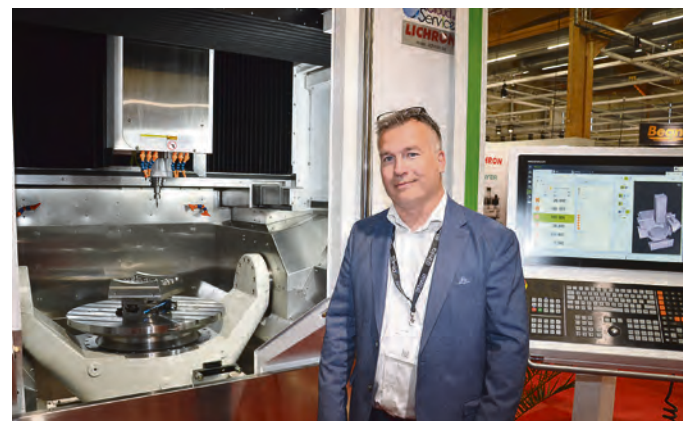
Magnus Chronholm, vd på Lichron berättar att 5-axliga flerooperationsmaskinen Hartford 5A-95Q är byggd för hög precision, simultan bearbetning och komplexa detaljer.
