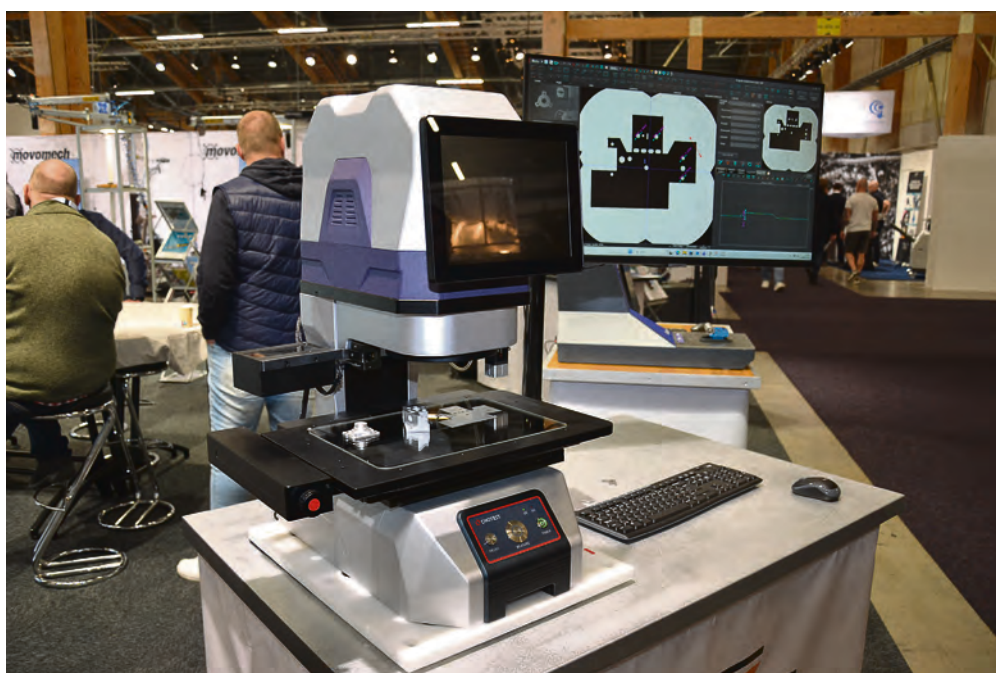
Nya Chotest Flash Measuring Machine Series är ett visionsystem som använder snabb högupplöst kamera och bildanalysalgoritmer för att utföra mätningar inom några sekunder.
