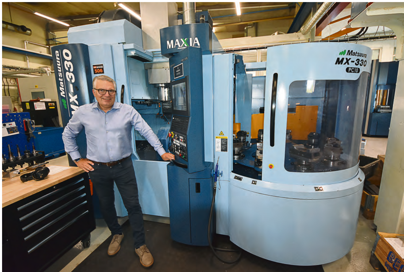
MATSUURA MX 330, 5-axlig vertikalfräs med palettsystem. 10 platser, perfekt för större serier.
