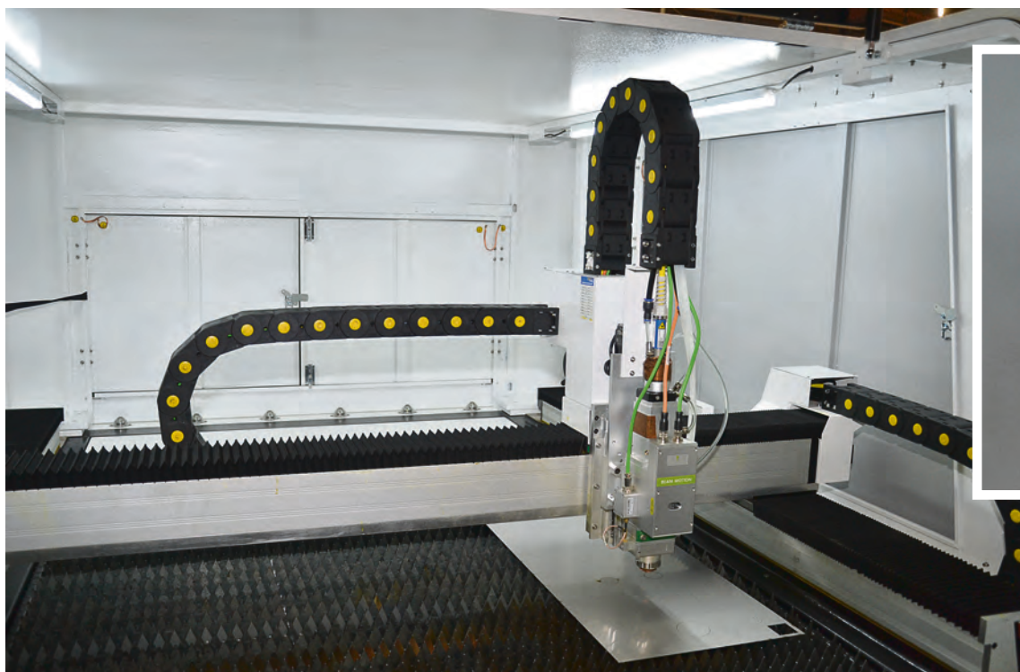
Fiberlasermaskinen LF1313 från kinesiska Gweike är perfekt för körning av små serier och prototyper, och klarar att skära ner till 0,1 millimeter.
