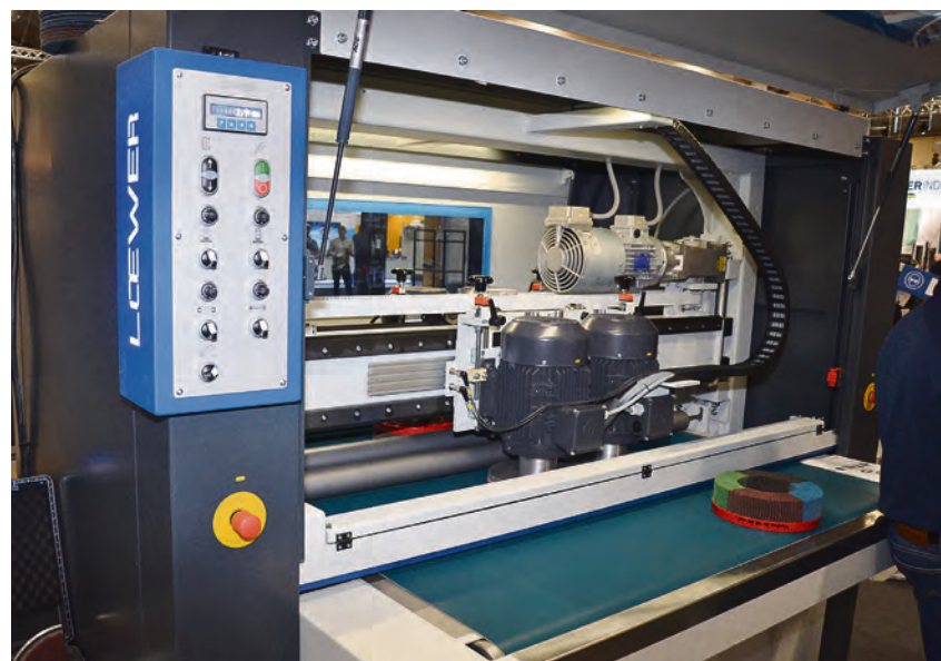
LOEWER Discmaster 4 är utvecklad för att effektivt förbättra kvaliteten på plåtdetaljer efter stansning, laserskärning, och plasmaskärning.
