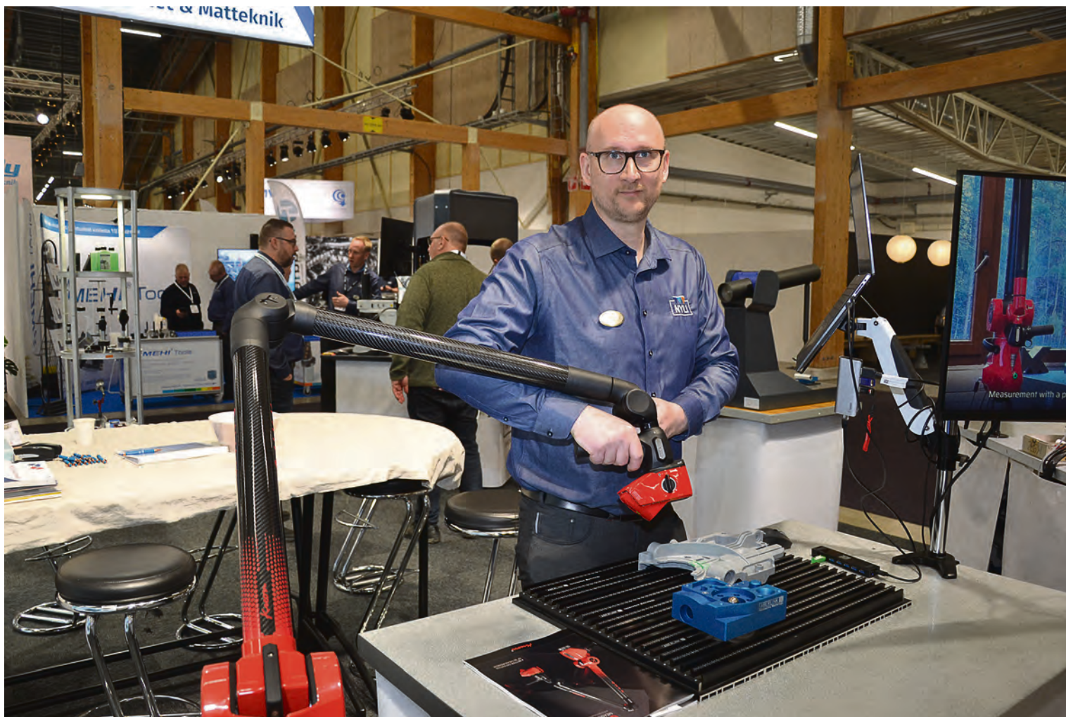
Kristian Thorn, som är ansvarig för utveckling, service, konstruktion och support vid NYLI Metrology visar upp mätarmen Kreon Onyx som används för 3D-mätning och laserscanning av komponenter och verktyg.
