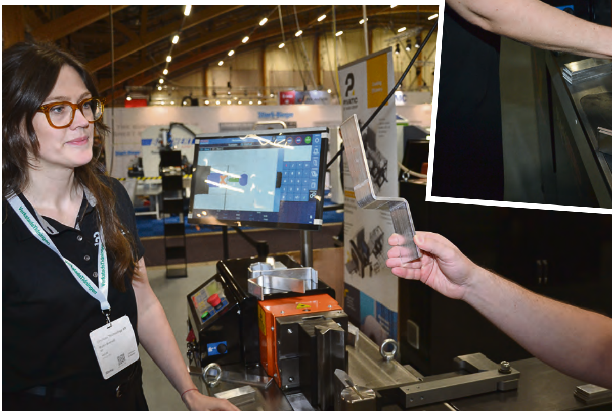
VaskiBEND Prodigy är särskilt utformad för effektiv bearbetning och bockning av plattjärn, och koppar- och aluminiumskenor.
