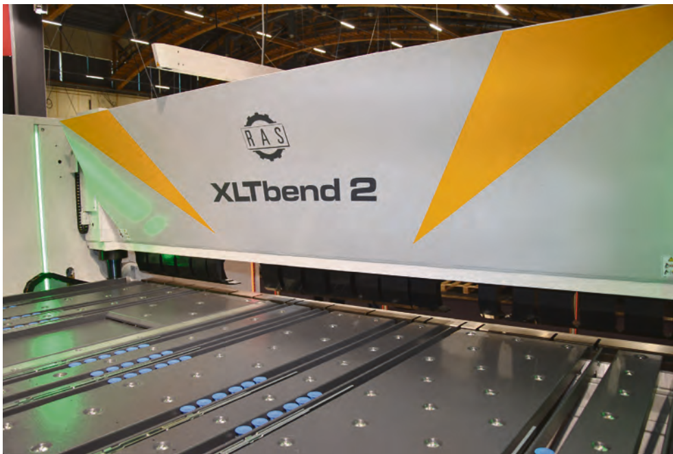
RAS XLTbend2 är en avancerad och flexibel panelbockningsmaskin, speciellt konstruerad för att bocka komplexa detaljer som kassetter, paneler och lådor med hög precision.
