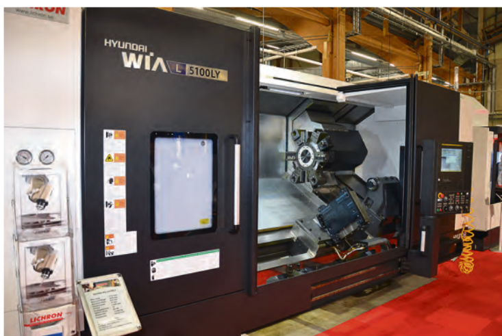
CNC-styrda svarven Hyundai WIA L5100LY var en av mässans största svarvar med svarvlängd på 2070 millimeter, en svarvdiameter på 610 millimeter, och en chuckstorlek på 21 tum.
